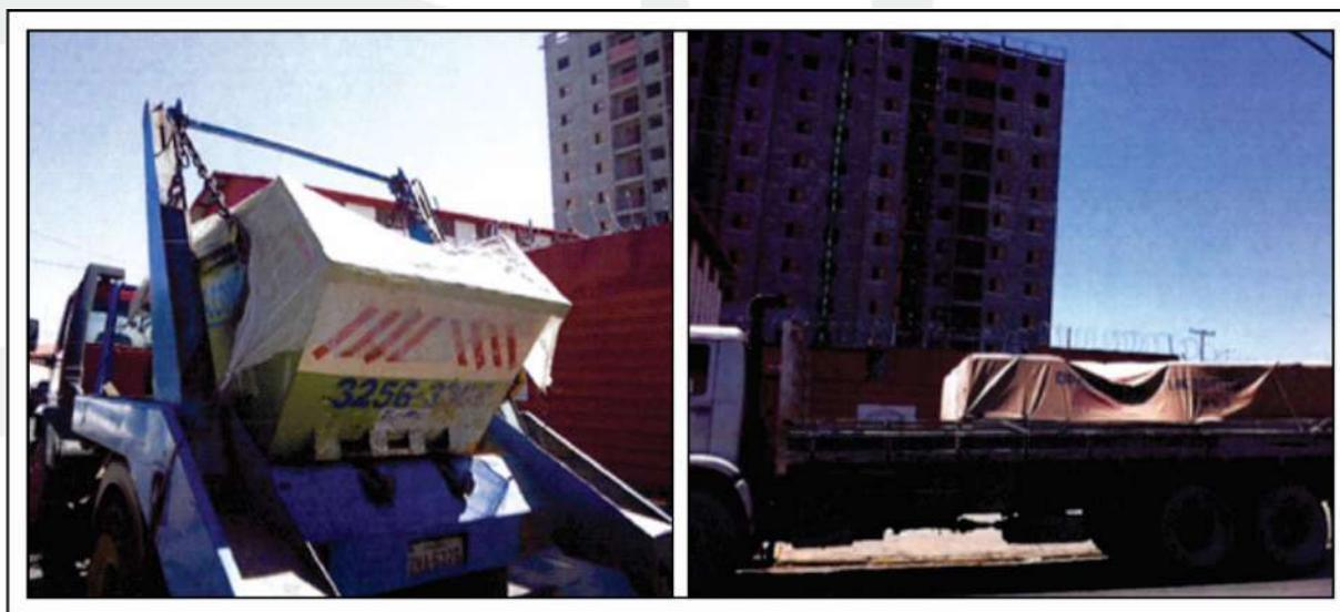
Figura 15. Exemplos de “lonamento” em caçamba de entulho e caminhão.
