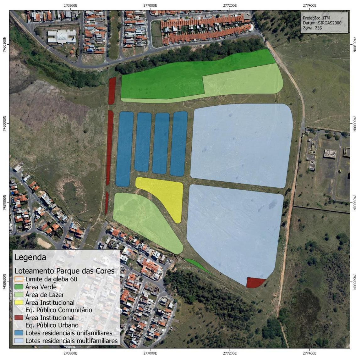
**Figura 3.** Croqui do parcelamento do solo com sobreposição em imagem aérea.
