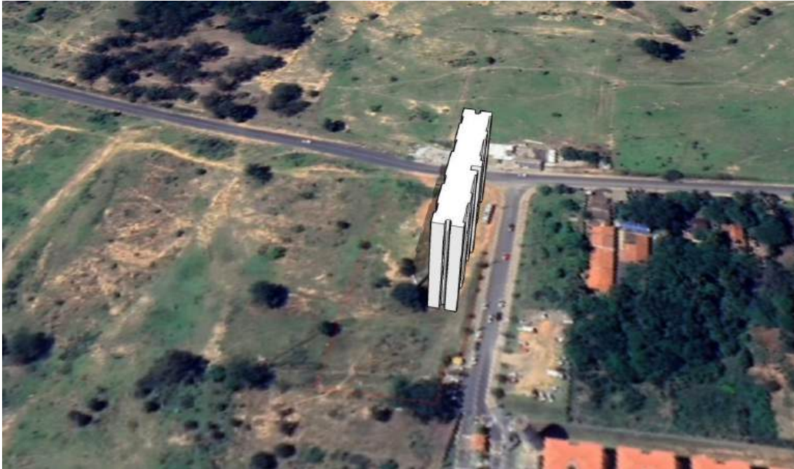
Figura 52. Simulação do sombreamento em 21 de setembro às 12h.
