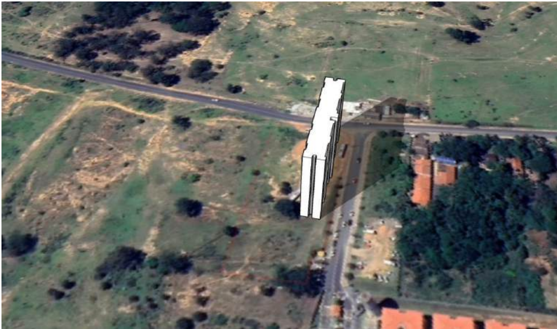
Figura 38. Simulação do sombreamento em 21 de março às 09h.
