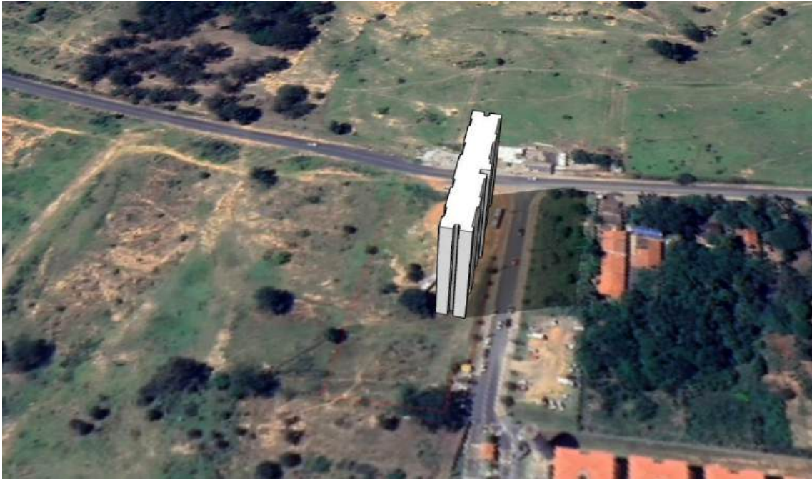
Figura 56. Simulação do sombreamento em 21 de dezembro às 09h.
