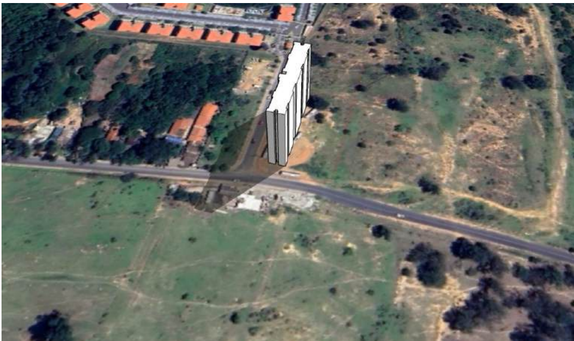
Figura 49. Simulação do sombreamento em 21 de setembro às 09h.
