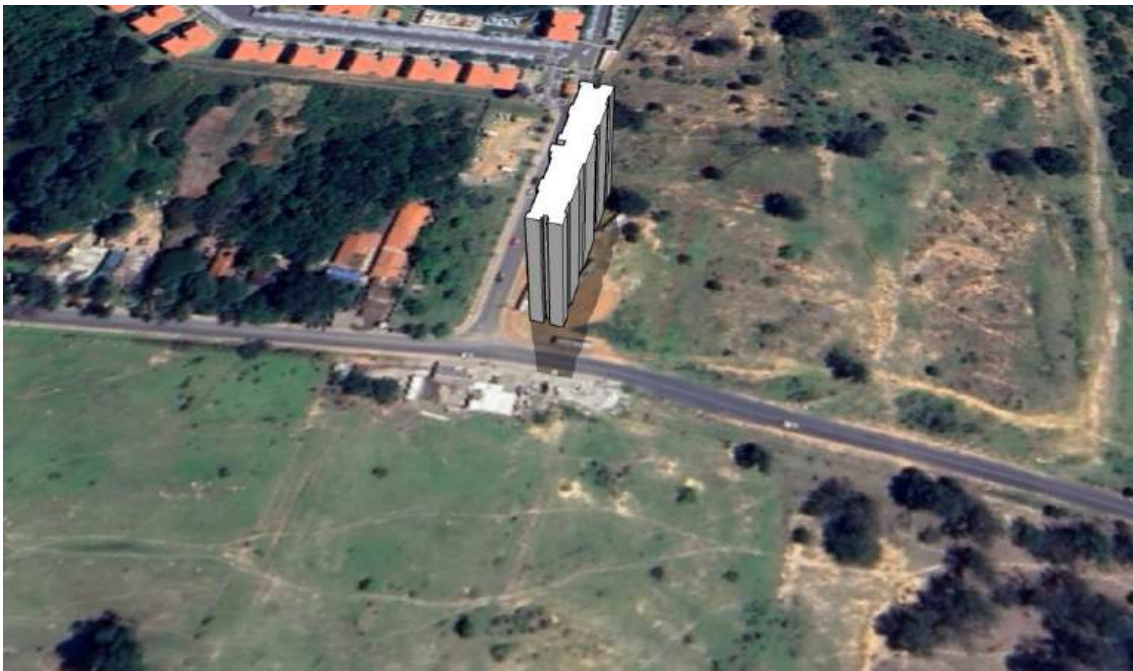
Figura 39. Simulação do sombreamento em 21 de março às 12h.
