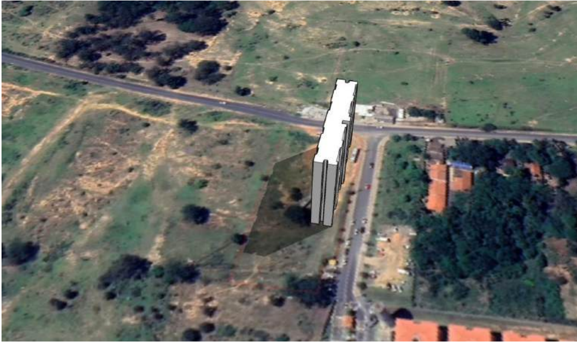
Figura 60. Simulação do sombreamento em 21 de dezembro às 15h.
