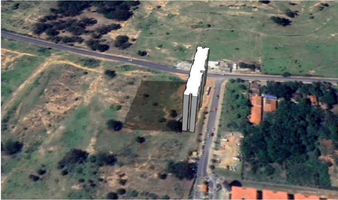
Figura 54. Simulação do sombreamento em 21 de setembro às 15h.
