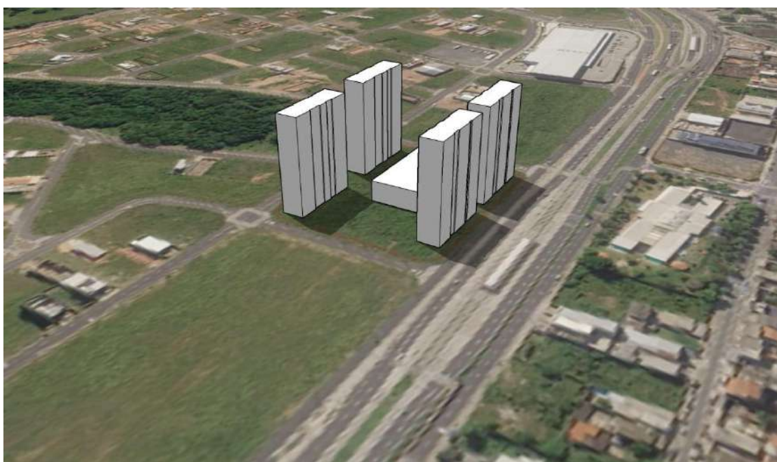
Figura 37. Simulação do sombreamento em 21 de março às 12h.
