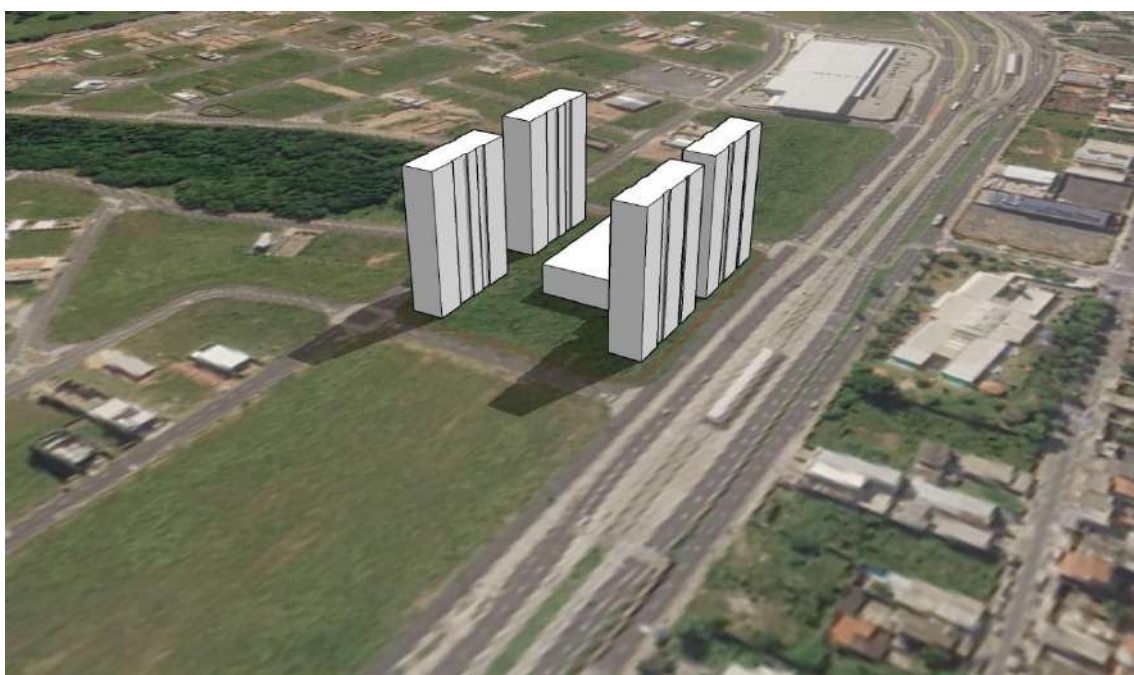
Figura 53. Simulação do sombreamento em 21 de dezembro às 09h.
