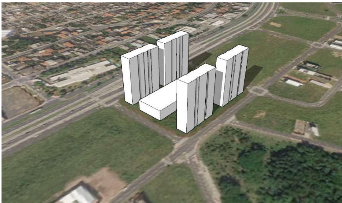
Figura 36. Simulação do sombreamento em 21 de março às 09h.
