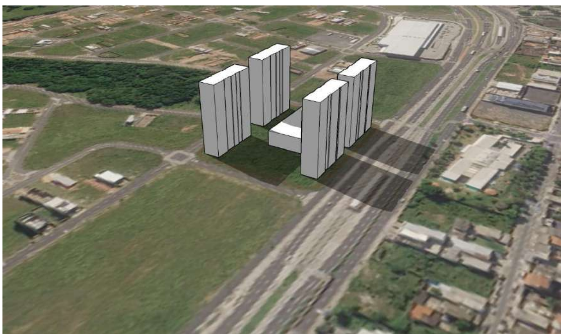
Figura 43. Simulação do sombreamento em 21 de junho às 12h.
