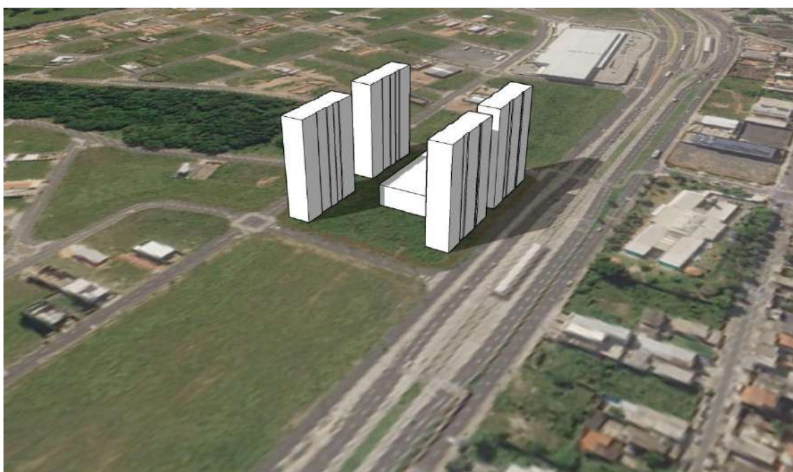
Figura 39. Simulação do sombreamento em 21 de março às 15h.
