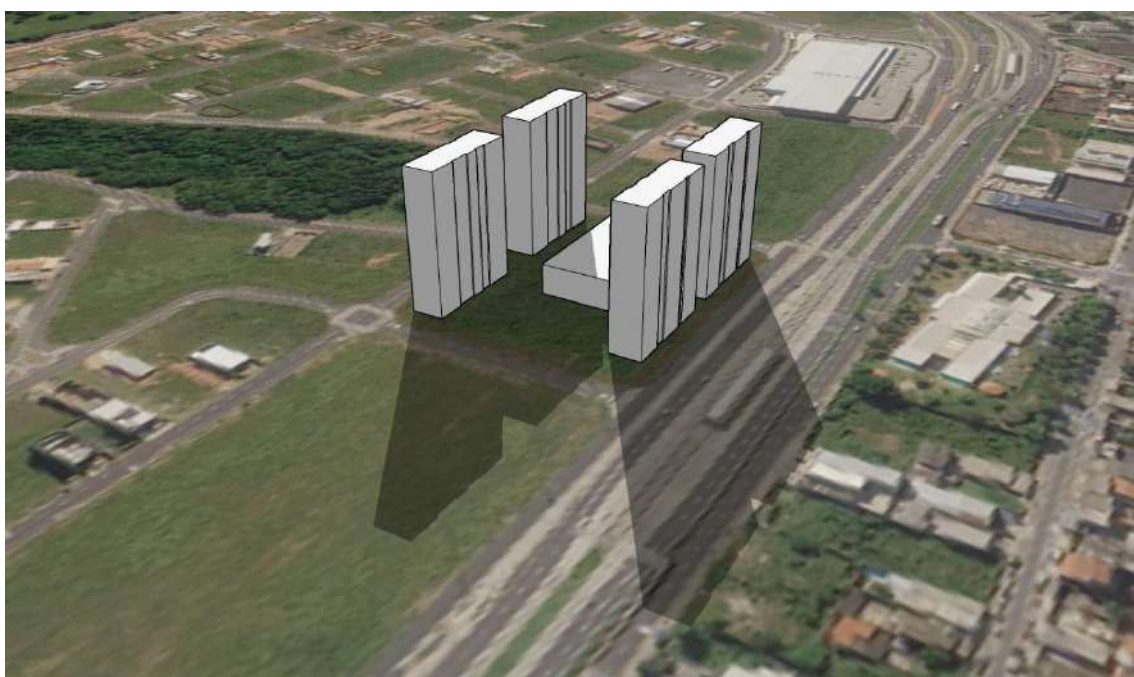
Figura 41. Simulação do sombreamento em 21 de junho às 09h.
