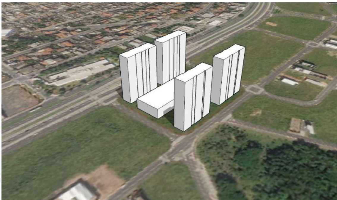
Figura 38. Simulação do sombreamento em 21 de março às 12h.
